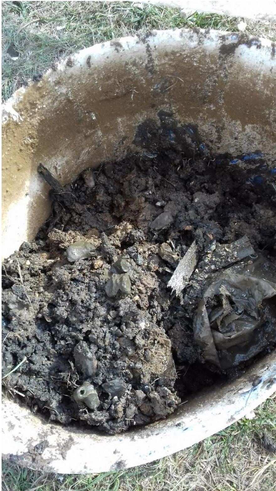
PLATE 17: BH04 LANDFILL MATERIAL
